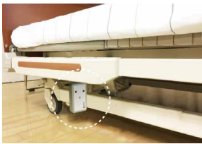
3Sセンサー 型式：3S-1 サイズ：135 × 76 × 35mm
