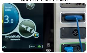
使用中のアクセサリはディスプレイ中に表示され、 そのアクセサリが接続されている ソケットのフレームが点灯します。
